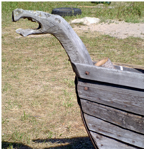
Ил. 1. Нос современной «килевушки» водлозерского мастера Ф. Спирина (носовая кокора изогнута по плавной дуге и сверху украшена фигурой в виде головы фантастического существа). Куганаволок, 2014 г. Фото К. Логинова
